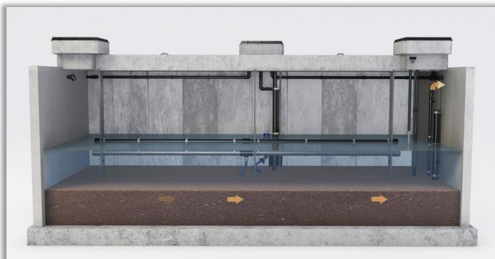
Figure 6 : SBR - Phase de purge des boues
