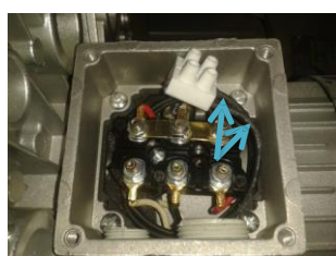
Fig-30 : fils thermosonde
