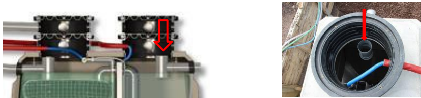
Fig 5a : Té d'échantillonnage dans une station Oxyfix® 27EH
