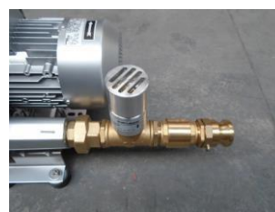
Fig-25 : Raccord côté surpresseur
